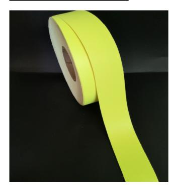
Il prodotto è essenzialmente composto da un tessuto ignifugo sul quale sono applicate delle microsfere a indice di rifrazione noto e ad altissima rifrangenza, immerse in una resina contenente uno strato retroriflettente giallo fluorescente. Tale resina, di natura poliuretanica, ha inoltre funzione di legante ed è dotata di elevata flessibilità e resistenza alle sollecitazioni meccaniche e chimico-fisiche. Il prodotto è disponibile anche nella versione traforata.
