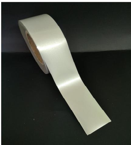
Il prodotto è formato essenzialmente da microsfere metallizzate, aventi indice di rifrazione noto e costante, parzialmente incorporate in un film di poliestere removibile (frontale) e applicate in modo permanente ad un termoadesivo base copoliestere, dotato di notevoli caratteristiche di flessibilità e di una eccellente adesione ai più comuni tipi di supporto.
